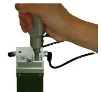
専用エアガンによるAポート注入例
