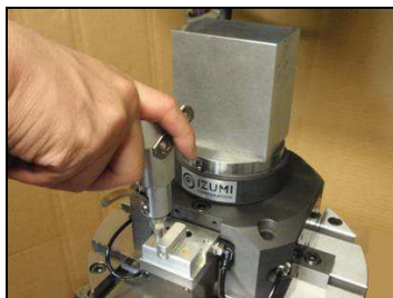
● 専用エアーガンによるBポート注入例
