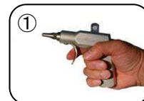
● 専用エアーガンによるAポート注入例
