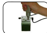
● 専用エアーガンによるAポート注入例
